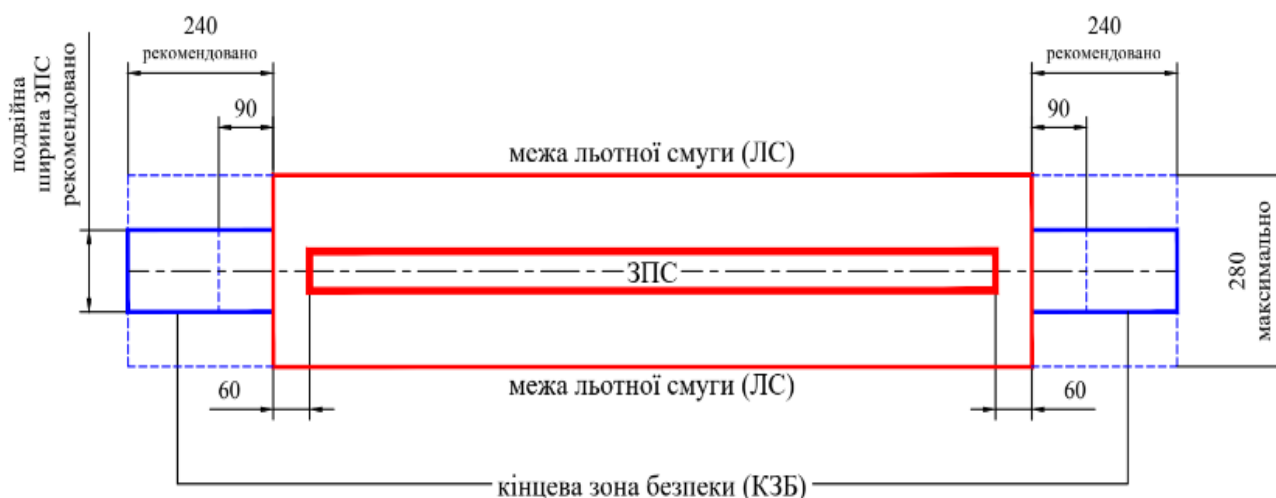
Рисунок А.3 – Кінцева зона безпеки ЗПС з кодовим номером 3 або 4
