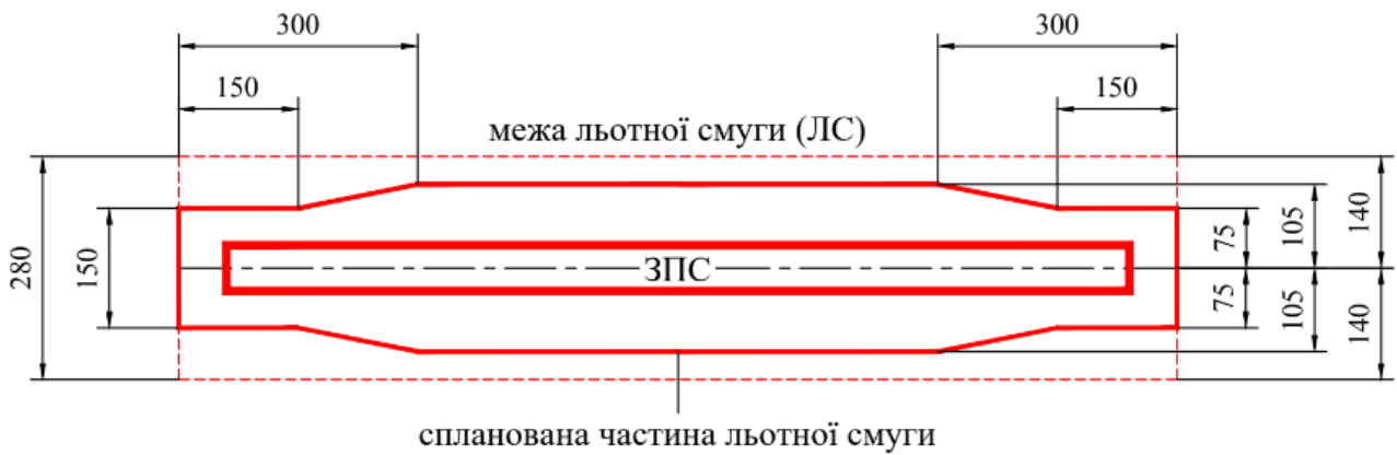
Рисунок А.4 – Спланована частина ЛС, що включає ЗПС з кодовим номером 3 або 4, обладнану для точного заходу на посадку
